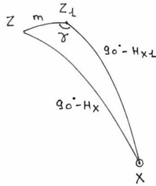
Nota : on remarquera que l'angle  $\gamma$  est le gisement de l'astre s'il n'y a pas de dérive (vent et/ou courant) ; pour effectuer la correction, il est nécessaire de connaître l'azimut de l'astre (mesure ou calcul approché) que l'on retranchera de l'angle de route fond suivie pour obtenir l'angle  $\gamma$ .
