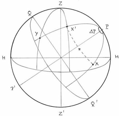
Dans le triangle ZX'Y, on connaît les 3 côtés qui sont les deux distances zénithales et la différence des déclinaisons des deux étoiles  $\Delta D$ . On peut donc calculer l'angle en Y :
